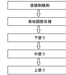
塗替え塗装工施工フロー
